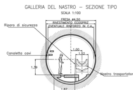
Sezione del tunnel per il nastro trasportatore del tout venant alla cementeria
